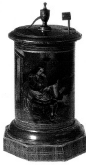
ŞEKİL 76. “Döbereiner çakmağı” (1840): Çakmaktaşı ve de manyetosuz ilk çakmak niteliğindeki bu alette, hava ile hidrojen gazı karışımı, toz halindeki platin ya da süngerimsi platin üzerine gönderilmekte, orada katalitik bir etki sonucu hidrojen tutuşmakta ve küçük bir alevle yanmaktaydı (Alman Eczacılık Müzesi, Heidelberg). 47
